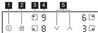
Folosiți câmpurile cu senzori pentru controlul aparatului. Afișajele, indicatoarele și semnalele sonore indică funcțiile active.
